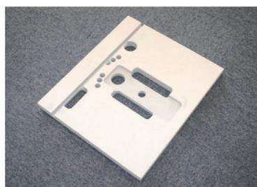
図8 穴あけ加工した断熱材 (JIS A 9510 相当品)
