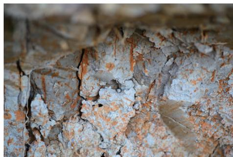
図4 土の採取場、堆積層のため採取はしやすいが耐火度は低い。
