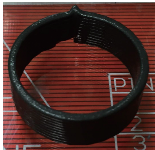
図3 押し出し3Dプリンターで成形した無焼成セラミックス
