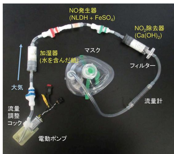
図7 小型NO発生装置の試作器
