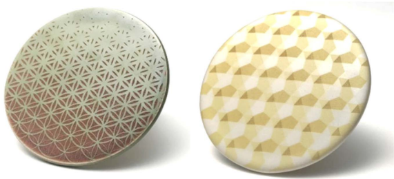
図5 酸化銅釉（左）、酸化銀釉（右）のレーザー加工後の釉薬
