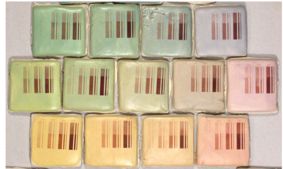
図6 レーザー照射後800℃焼成した釉薬（CuO 0.5%添加）
